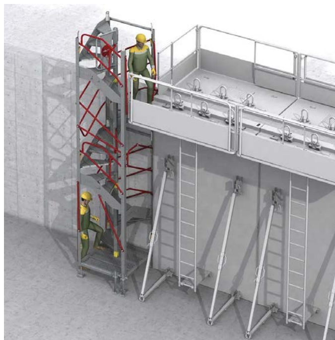
شکل ۵-۲۹- دسترسی ایمن به داخل گود
