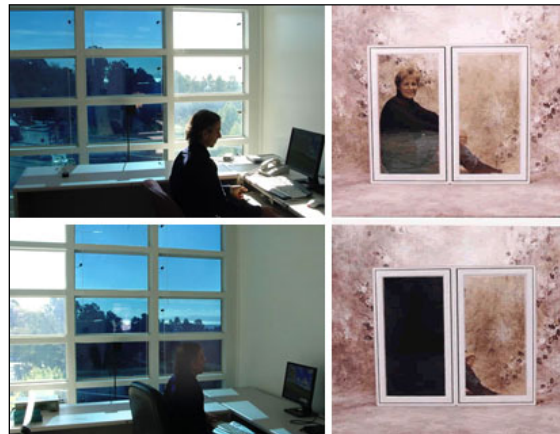
شکل ۱۲-۷۵- نمونه عملکرد پنجره‌های با شیشه‌های الکتروکرومیک
