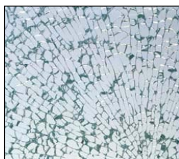
شکل ۱۲-۸۳- شکست در شیشه با عملیات حرارتی کامل
