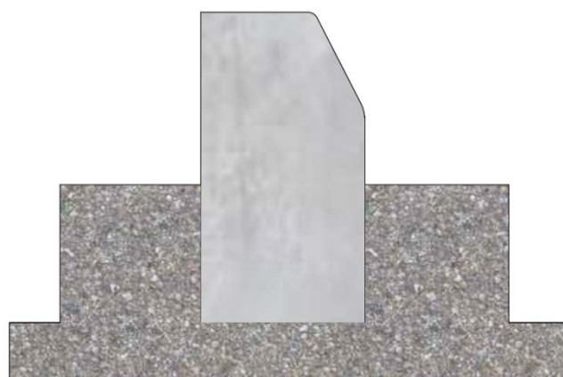
شکل ۱۳-۱۴- نمونه‌ای از اجرای صحیح ماهیچه در طرفین جدول
