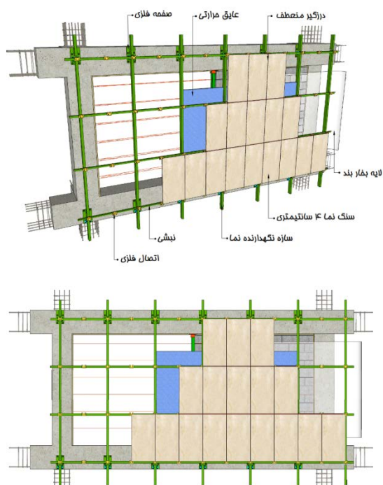
شکل ۴-۱۳- جزئیات اجرای نمای پرده‌ای سنگی
