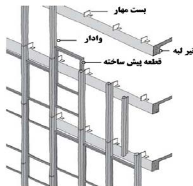
شکل ۹-۳- سیستم نمای پرده ای شامل قطعه-وادار
