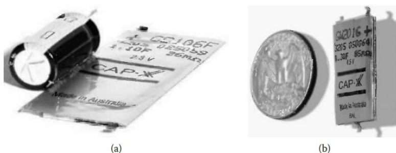
شکل ۱-۸۵: سلول کیسه‌ای (CAP-XX © EC) ساخته شده از کربن فعال و الکترولیت آلی. (a) تک سلول ۲/۵ ولت. (b) دو سلول استک با اتصالات کوتاه برای فراهم نمودن ۵ ولت
