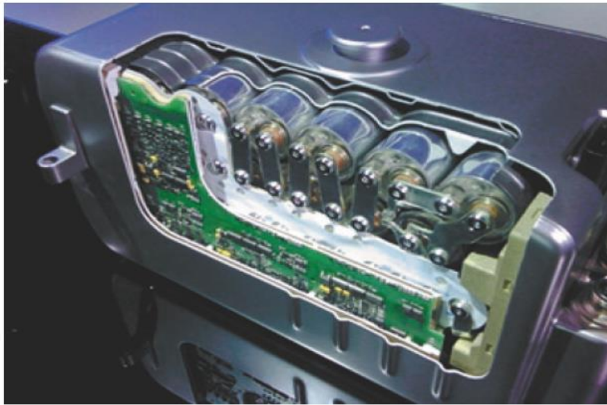
شکل ۱-۳۱: باتری لیتیوم یونی با طراحی بلوکی
