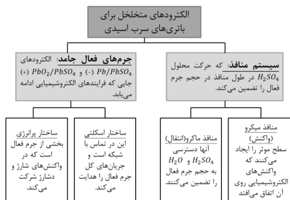
شکل ۲-۲۵: اجزای ساختاری جرم‌های فعال متخلخل تشکیل شده بر روی الکترودهای مثبت یا منفی
