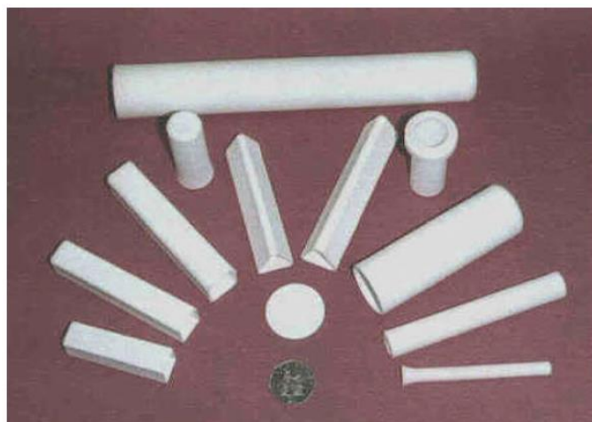
شکل ۵-۲: نمونه‌هایی از الکترولیت‌های جامد سرامیکی
