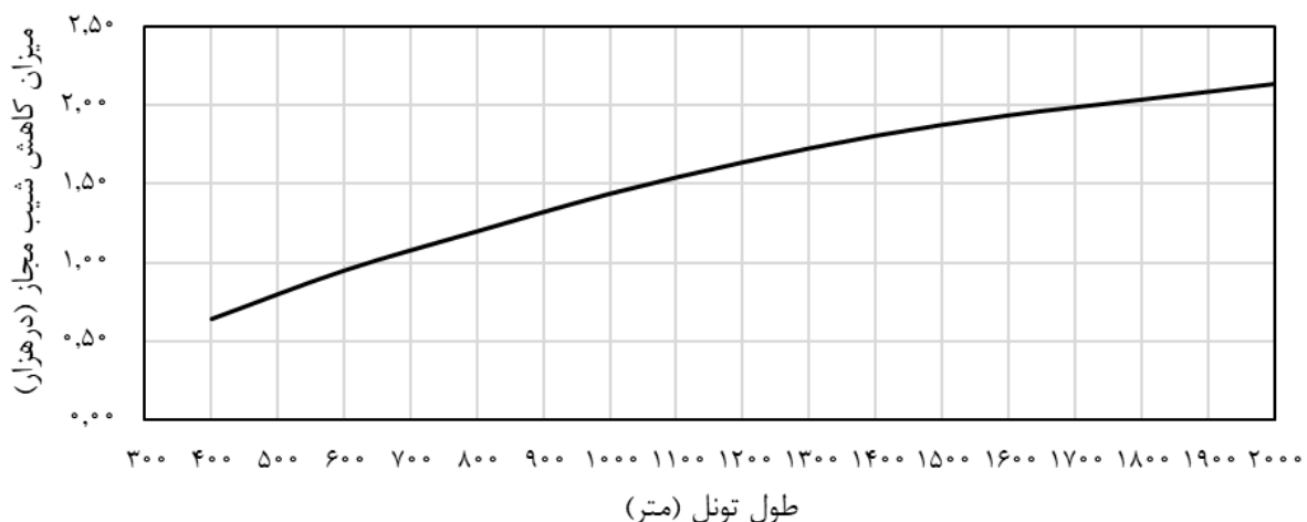
شکل ۷-۲ کاهش شیب مجاز بر حسب طول تونل
