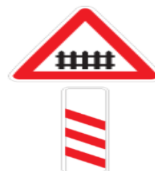
د: تقاطع جاده و راه آهن با راه بند نصب در
