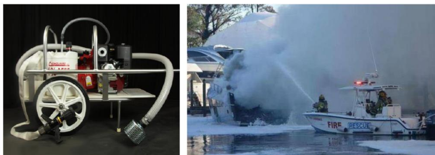
شکل ۱-۳۲- اطفاء کننده‌های سیار فوم ساز مستقر بر روی چرخ (سمت چپ) و بر روی شناور (سمت راست)
