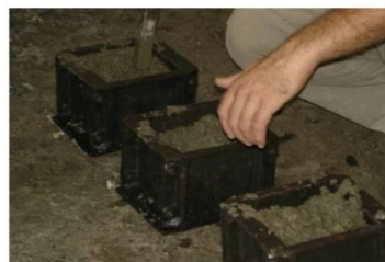
تهیه نمونه مکعبی برای انجام آزمایش مقاومتی بر روی بتن
