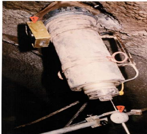
شکل ۷-۲- تصویر آزمایش کشش راک‌بولت
