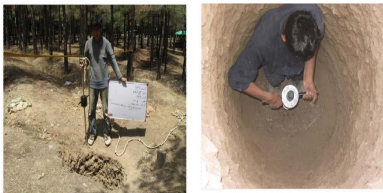
شکل ۳-۱۰- آزمایش ضربه و نفوذ استاندارد S.P.T در داخل چاه اکتشافی
