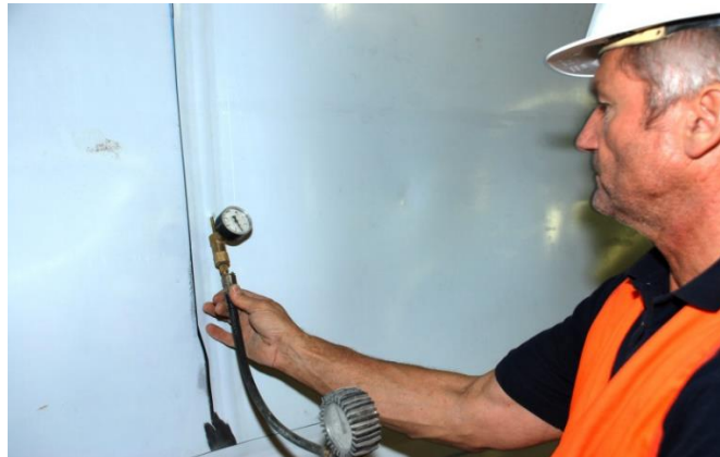
شکل ۵-۲۲- تست فشار هوا برای عایق بندی تونل
