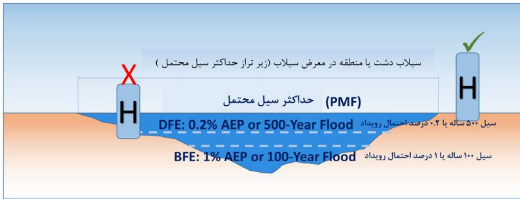
شکل ۴-۷ پهنه سیلابی رودخانه و حداکثر سیلاب احتمالی (PMF) برای احتمال فراگذشت سالیانه مختلف
