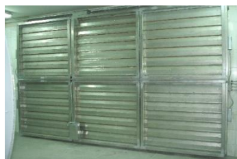
شکل ۳-۷ نمای هواساز در هنگام آزمایش
