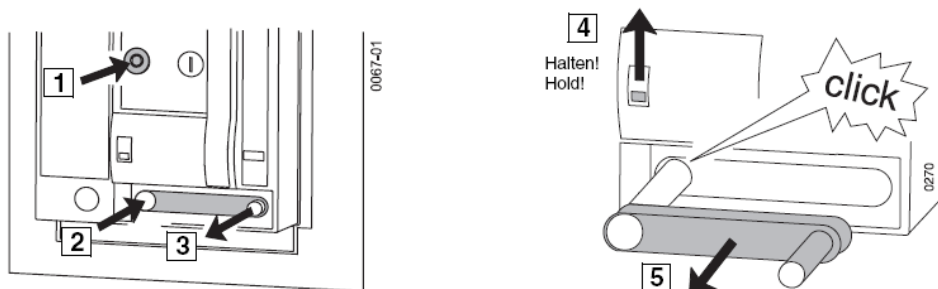
شکل ۲۶- نحوه تست کردن تابلوهای ACB
