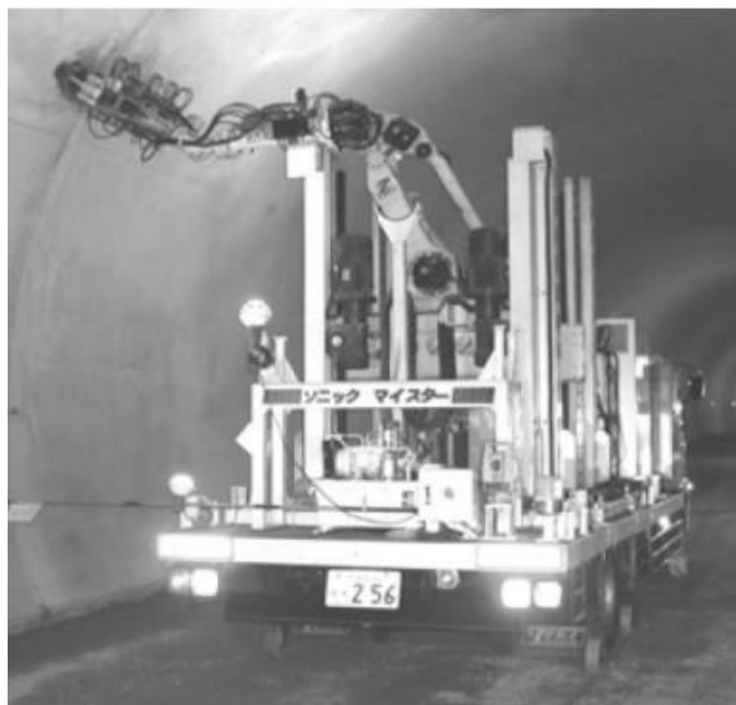
شکل ۱۸-۱ استفاده از روش‌های صوتی برای پایش مکانیزه سازه
