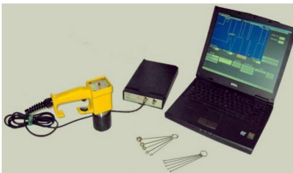
شکل ۲۶→ برخی تجهیزات مورد نیاز در آزمایش بازگشت ضربه
