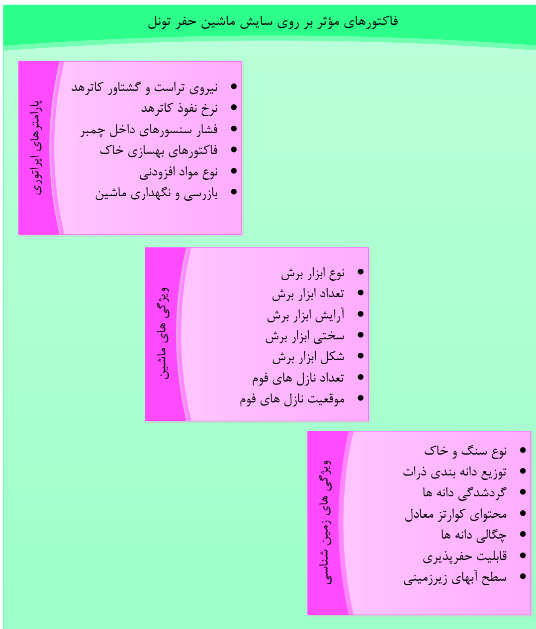
شکل ۲-۱۳: فاکتورهای مؤثر بر سایش ابزارهای برش و ماشین EPB-TBM
